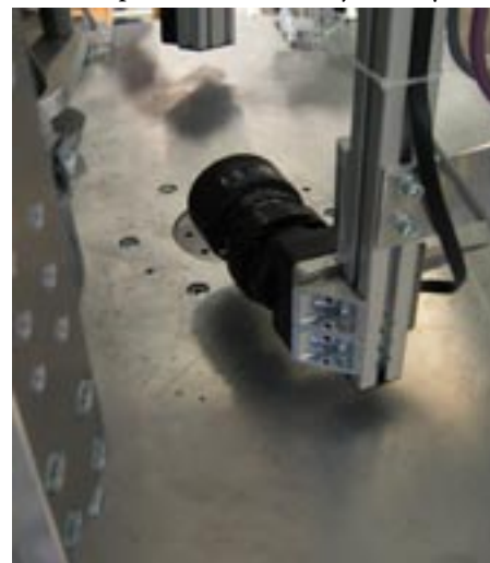
Kamera je umístěna tak, aby nepřekážela pohybu žádného mechanismu automatu
